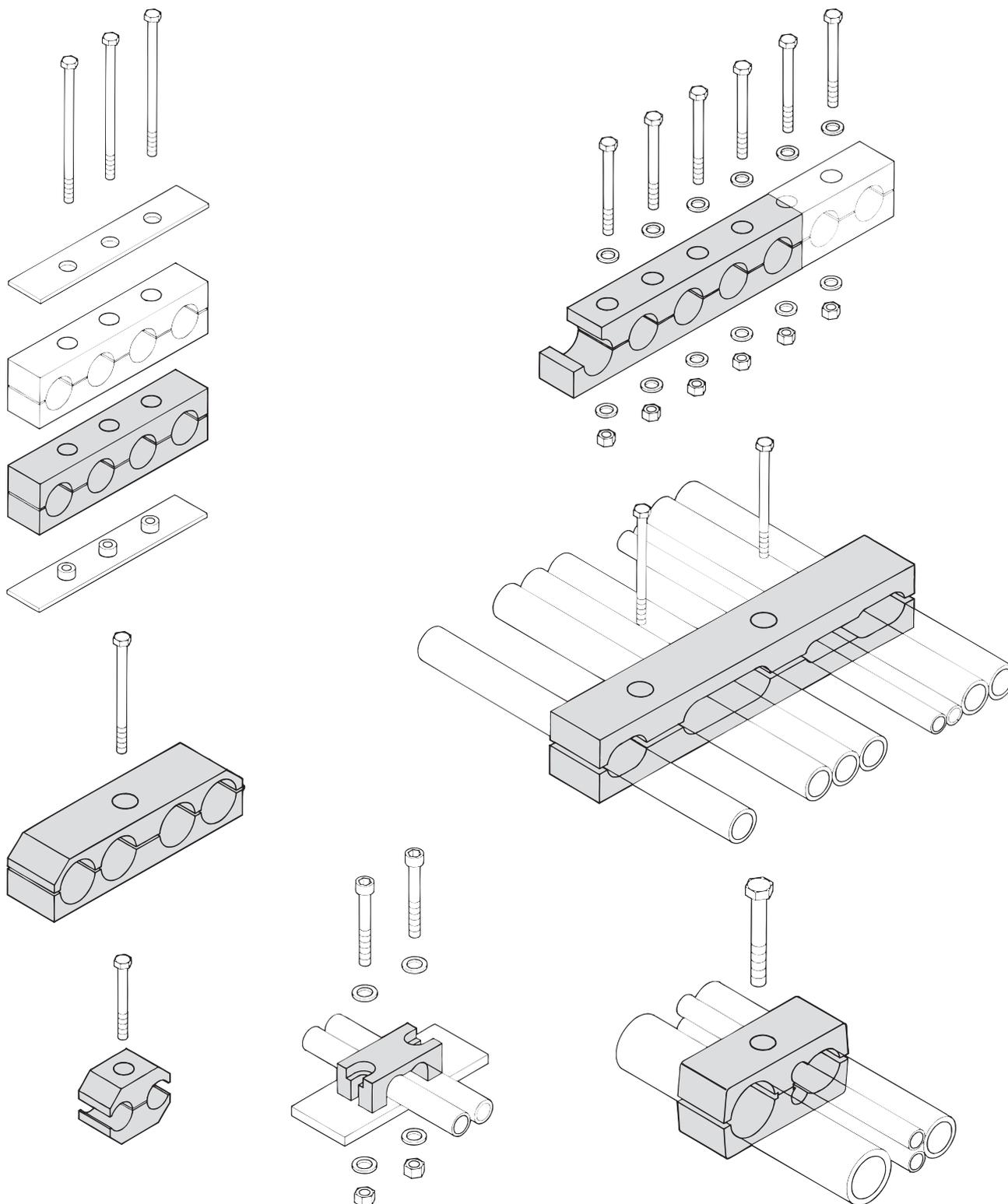
**Sämtliches Befestigungszubehör wie Schweißplatten, Deckplatten, Schrauben sowie Elastomereinsätze auf Wunsch lieferbar.**
